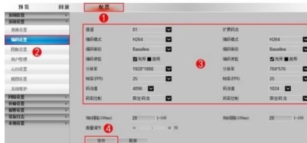
点击①配置，进入菜单→点击②编码设置，进入菜单→③可以对编码模式、等级、码流、等多种设置→④设置完成后，点击保存。
