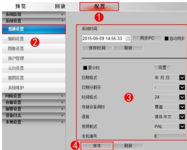
点击①配置，进入菜单→点击②普通设置，进入菜单→③可以对时间同步、日期的格式、时间格式、存储设备满时等多种设置→④设置完成后，点击保存。
